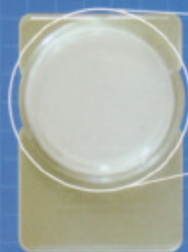
試験液に含まれる異物をフィルタに捕集します
